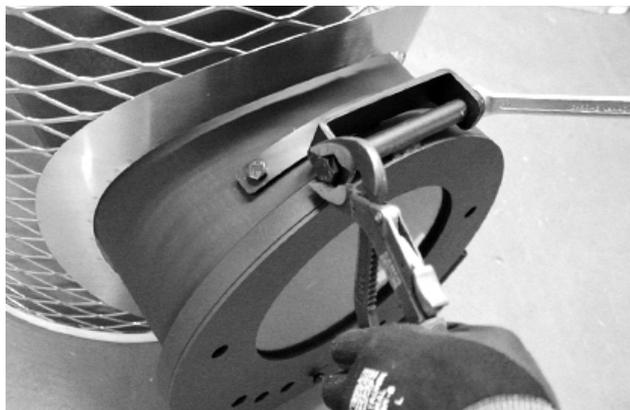
7. Снимите ось петли ключом на 17 мм и установите дверцу печи.
